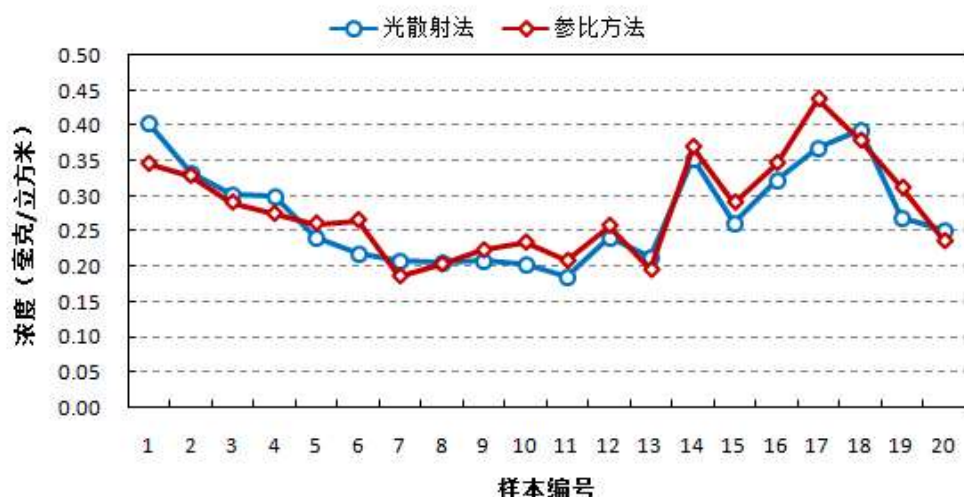
图 6-11 仪器商三光散射法和参比方法测试结果比对图
